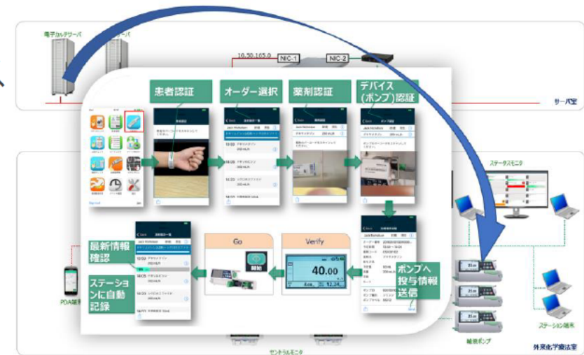
電子カルテからスマート輸液ポンプへのオーダー情報の送信 AMED 平成31年（令和元年）度「医工連携事業化推進事業」 （TERUMOとの共同研究）
