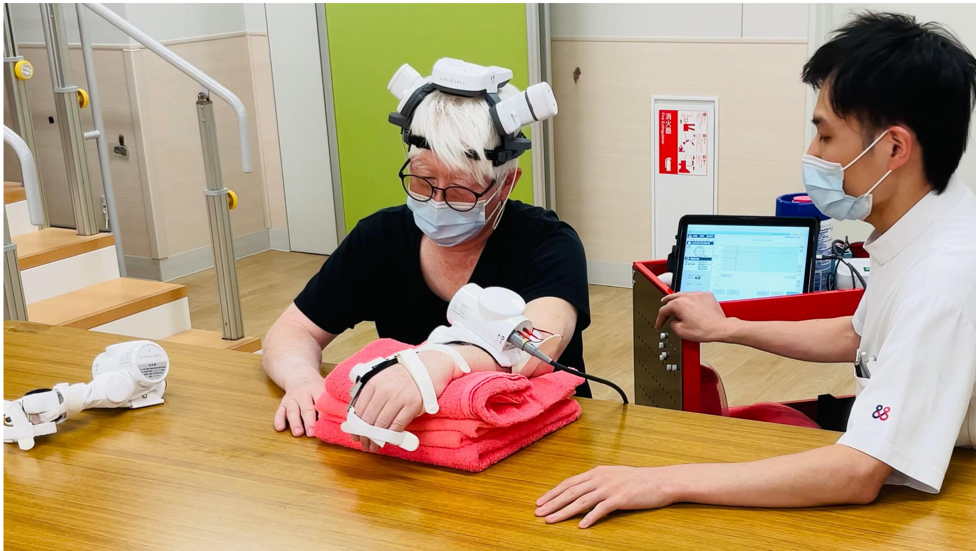
例：BMI（頭皮信号→ロボット駆動）による手指訓練のイメージ
